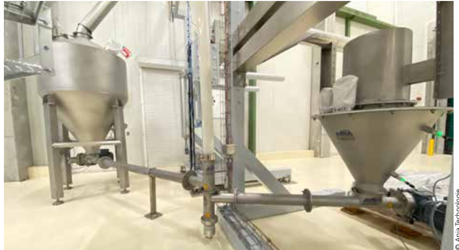
→ Le système est intégralement vidangeable, notamment grâce aux moteurs sur charnière qui se démontent facilement.
