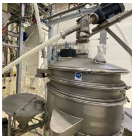
→ Le tamiseur vibrant de séparation densimétrique permet de gérer la granulométrie des légumineuses et si besoin de renvoyer vers le broyeur celles de diamètre trop important.
