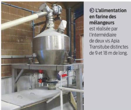
► L'alimentation en farine des mélangeurs est réalisée par l'intermédiaire de deux vis Apia Transitube distinctes de 9 et 18 m de long.
