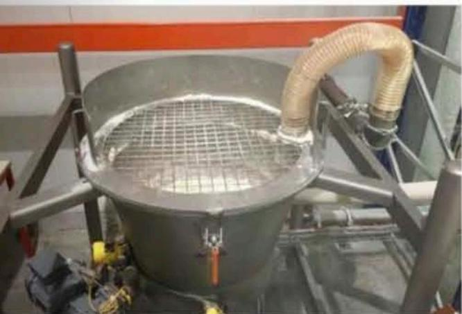
→ La trémie d'entrée intermédiaire d'une capacité de 200 kg laisse le temps aux équipes d'échanger les big-bags.
