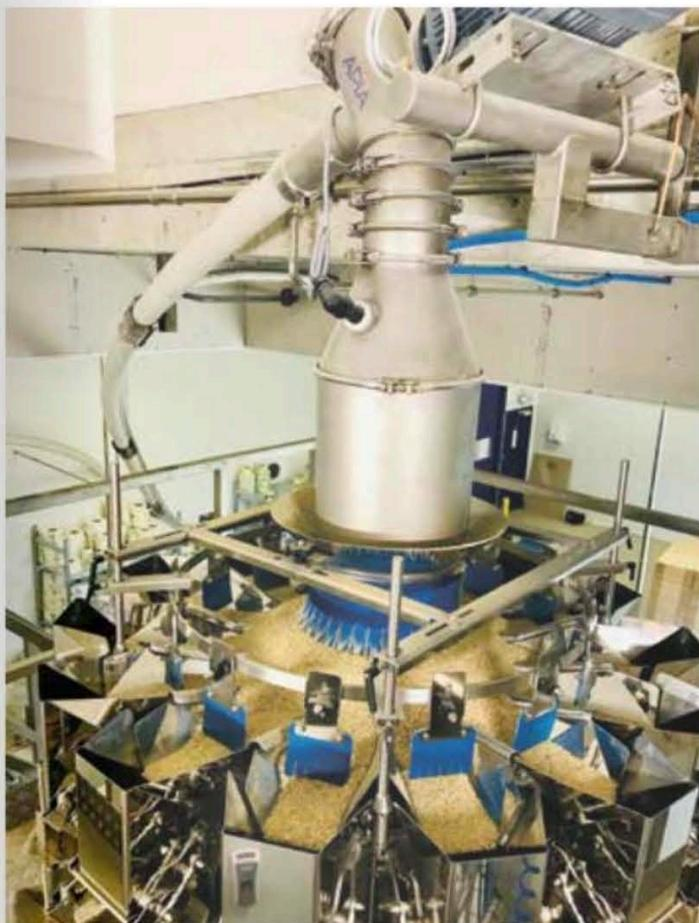
Apia Technologie réalise des installations dédiées au transfert de poudre et au dosage d'ingrédients.
