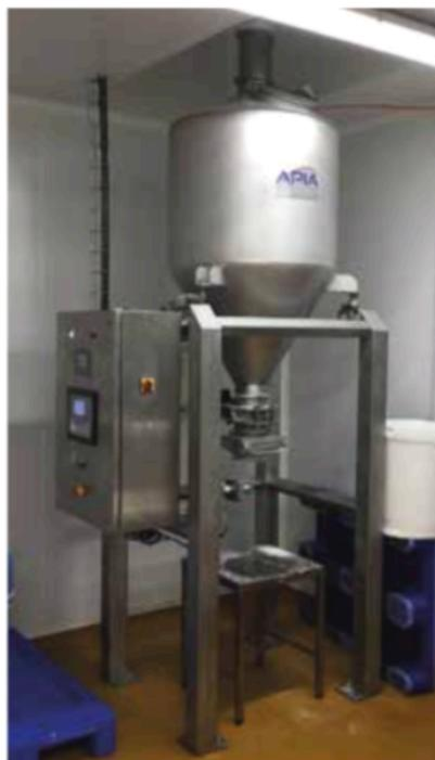
**VIBRAFLOOR :** Extraction par plancher vibrant - p.50
