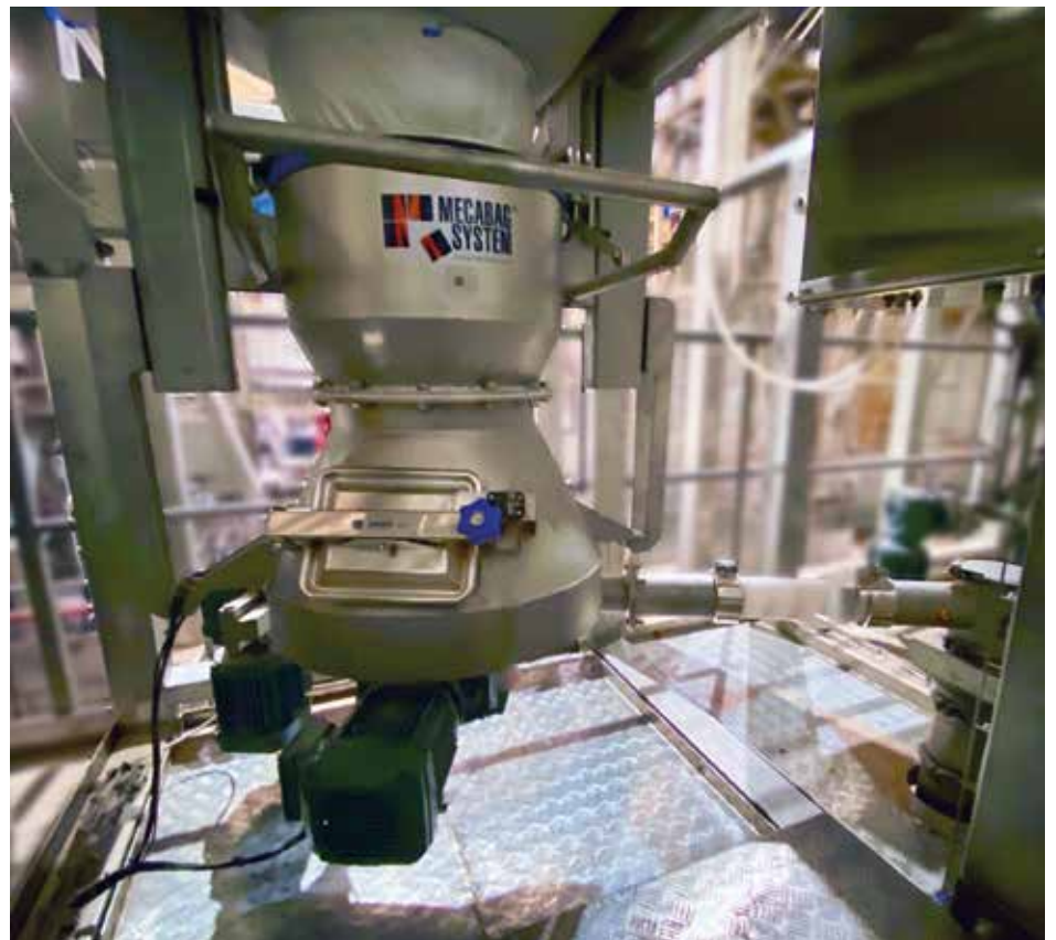
Vis de dosage intégrée.
