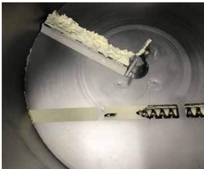
| Trémie à vidange intégrale équipée d'aube de dévoutage.
