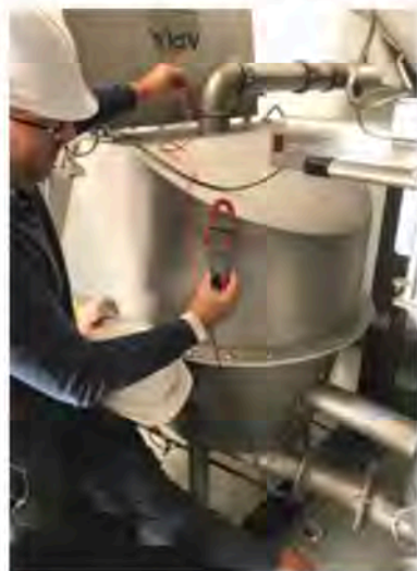
Test de conductivité zone ATEX des équipements Apia Technologie.
