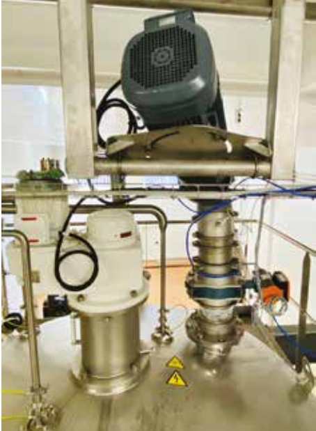
Implantation du système par vis flexible en haut de fondoir. Le sucre s'écoule par gravité.
