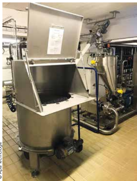
▷ Vide-sacs avec fond plat et aube de prémélange alimentant le disperseur.
