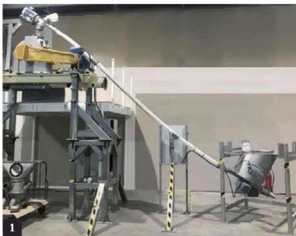
**1** - Precimicron est doté de quatre vis Apia qui alimentent chacune quatre machines, deux broyeurs et deux tamiseurs.
