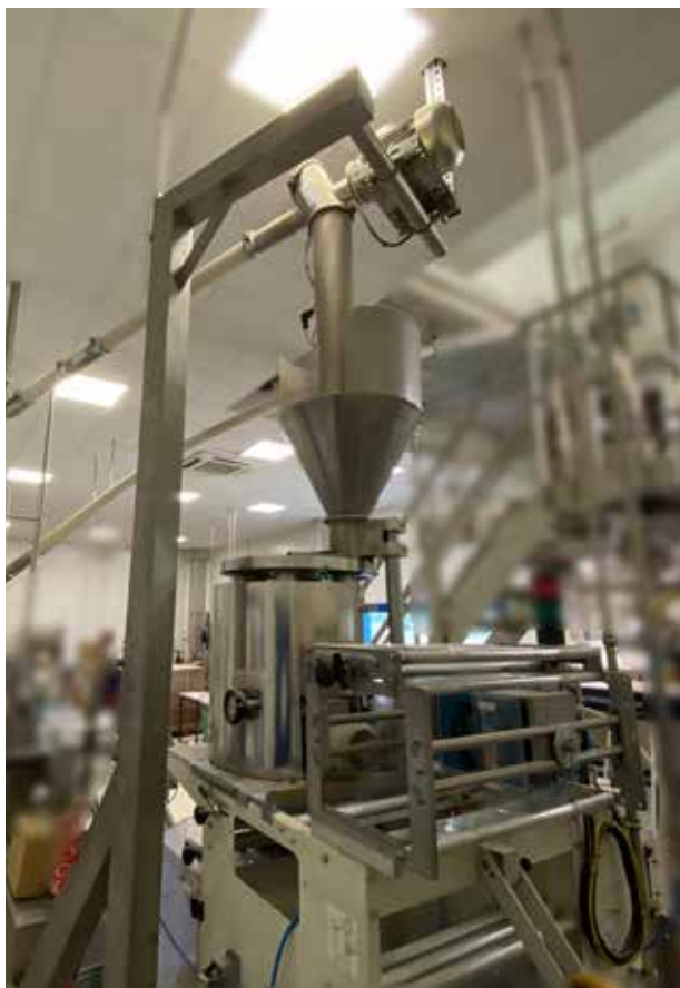
→ Les systèmes Transitube permettent une flexibilité d'installation et de limiter l'emprise au sol en convoyant le produit du niveau zéro vers le haut.
