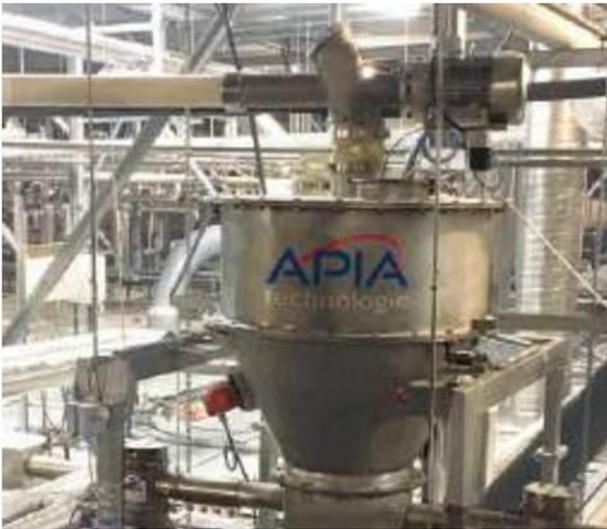
La trémie pesée implantée dans les combles dose et alimente les 2 mélangeurs.
