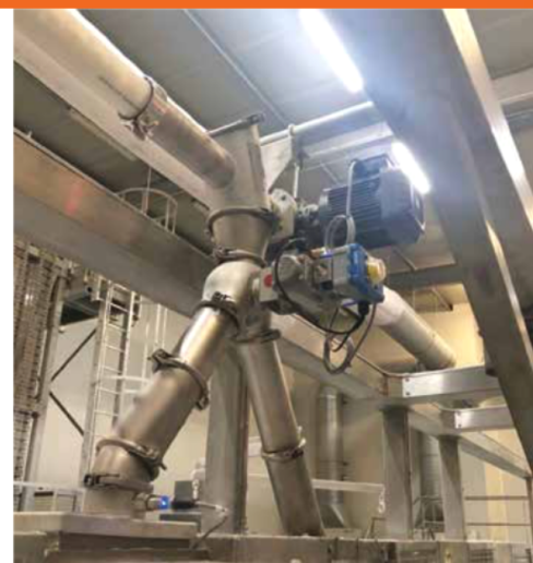
Systèmes d'aiguillage pour le transfert de la farine vers les farineurs.
