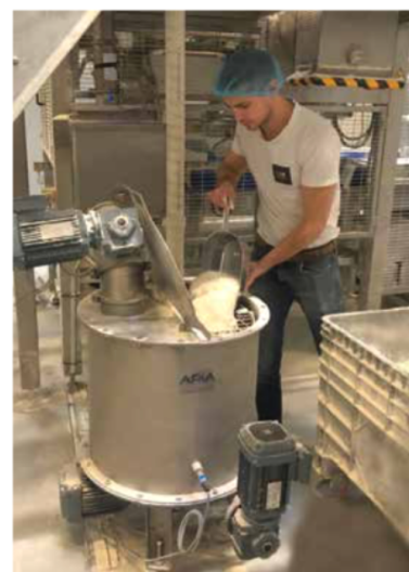
Ligne vide-sac avec dévôteur : l'opérateur alimente manuellement la trémie de départ.
