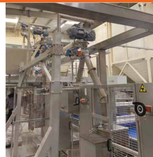
Système en cascade alimentant les farineurs.
