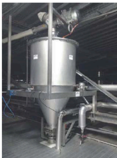
Une vis Apia Transitube entre la station de vidange et le mélangeur remplace le déversement manuel des sacs dans le batch.
