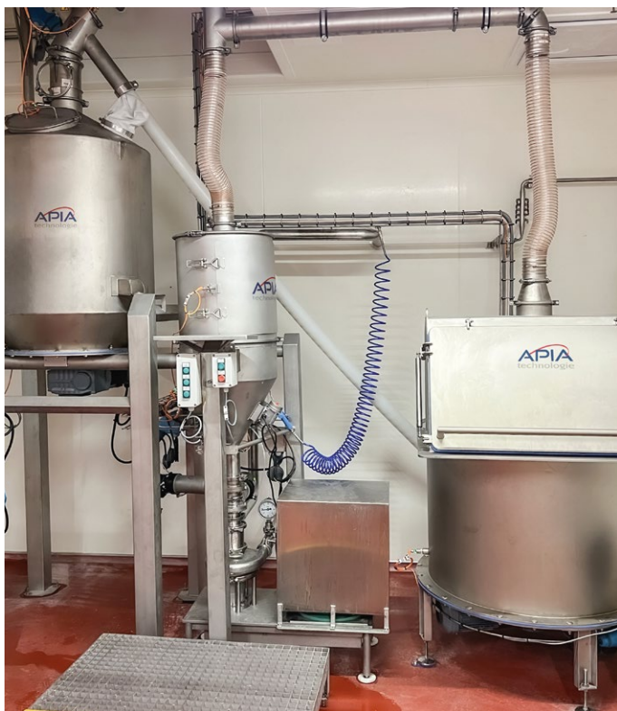
Unité de poudrage automatisée en zone dédiée.
