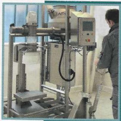
**APIA Technologie** présente sa nouvelle Ensacheuse Pe-seuse Mobile (EPM). Au-delà de sa fonction d'ensachage, l'EPM permet d'optimiser le flux des matières premières en vrac dans les usines alimentaires, en termes de productivité et d'hygiène. Cet équipement « 2 en 1 » mobile
