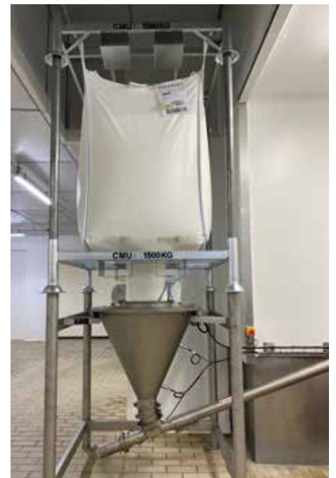
Station de vidange big bag avec trémie conique.
