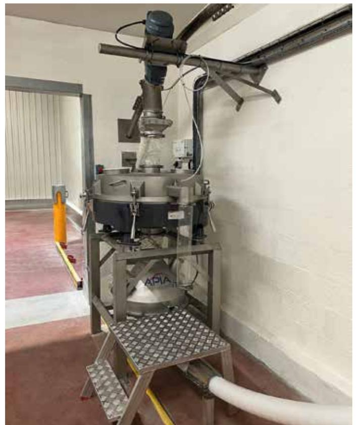
Apia Technologie a intégré un ensemble de transfert et un piège magnétique.
