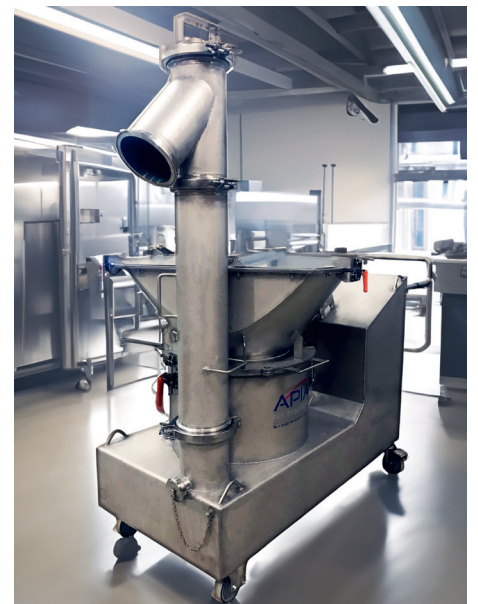
■ L'ETB permet d'émotter, de tamiser ou de broyer les produits en vrac.
