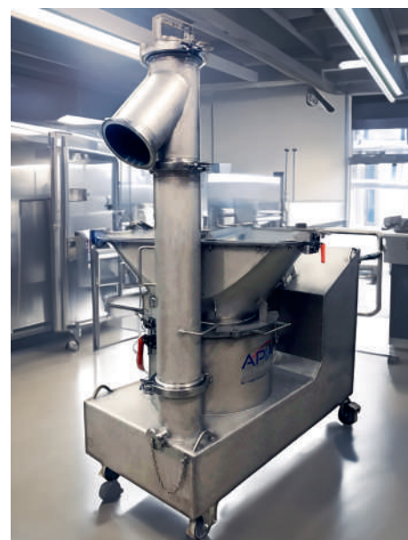
■ L'ETB permet d'émotter, de tamiser ou de broyer les produits en vrac.
