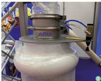
3 La tête de remplissage étanche et hygiénique d'Apia technologie peut supporter différents diamètres : 150 à 250 mm en entrée, 200 à 400 mm en sortie.
