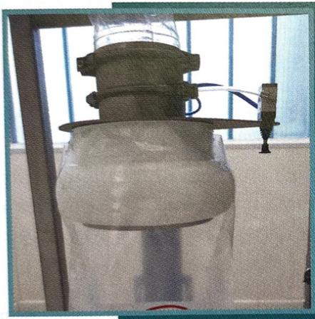
**APia Technologie** commercialise une gamme de têtes de remplissage avec joint gonflable d'étanchéité. Cette goulotte de remplissage équipe en particulier les machines de dosage, de pesage et d'ensachage des poudres alimentaires. Disponible dans de nombreux diamètres, la tête de remplissage s'installe facilement en sortie de tamiseur, de mélangeur, de broyeur ou de stockage
