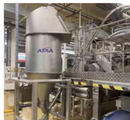
Station vide sacs avec tampon de grande capacité et hotte.
